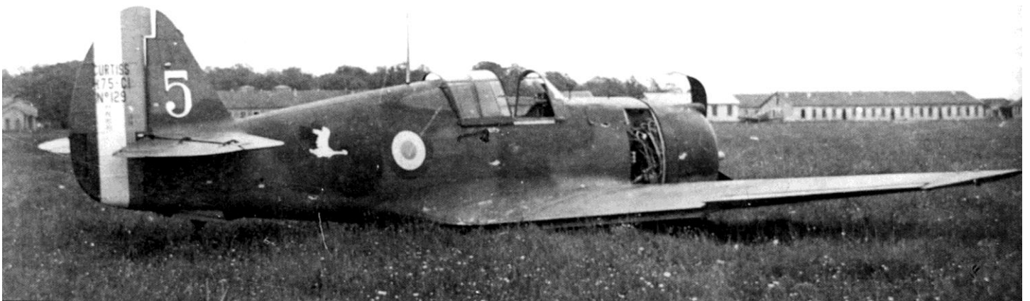
18 mai 1940 – Toul – Le Curtiss H-75 n°129 du lieutenant HOUZÉ contraint de se poser sur le ventre - Pompe de train d'atterrissage détruite par un mitraillage
