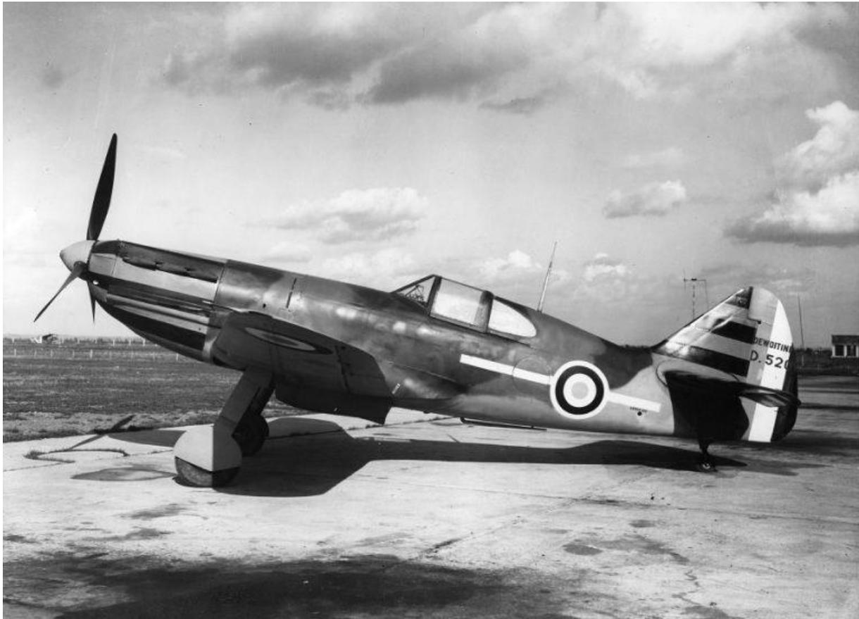
*Avion de chasse monoplace à voilure basse CANTILEVER*
