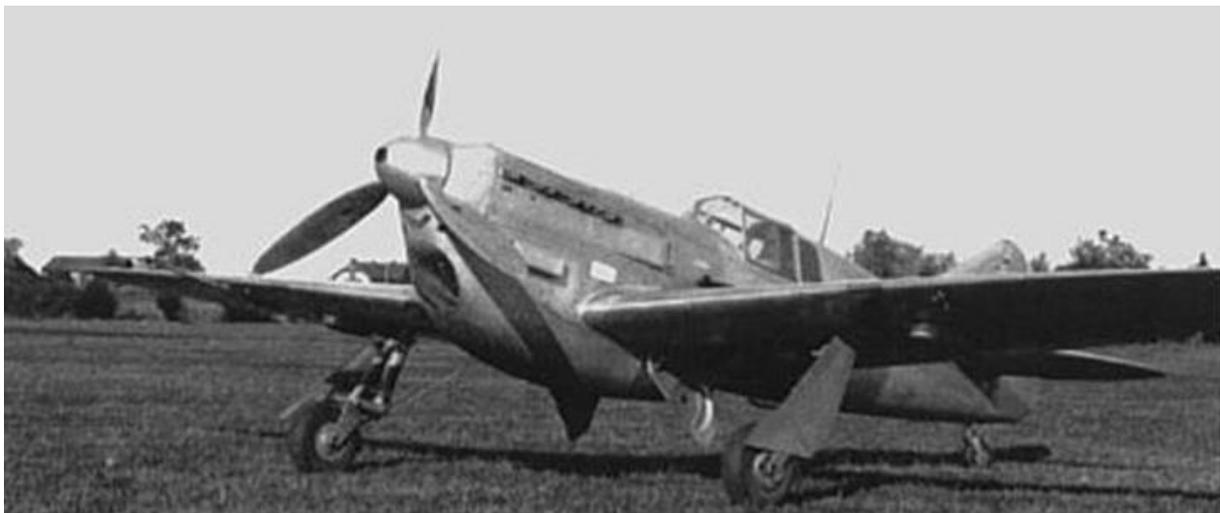
*Avion de chasse monoplace 2° génération à voilure basse elliptique*
