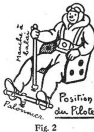
Au bout du plan fixe se trouve fixé horizontalement le *gouvernail de profondeur* qui peut se relever ou s'abaisser (Fig.3) par le jeu du *manche à balai* qui est dans les mains du pilote (Fig.2).
