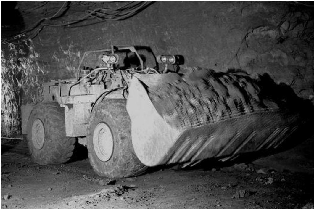
Figure 8 : Caterpillar 980 : Transport en charge
