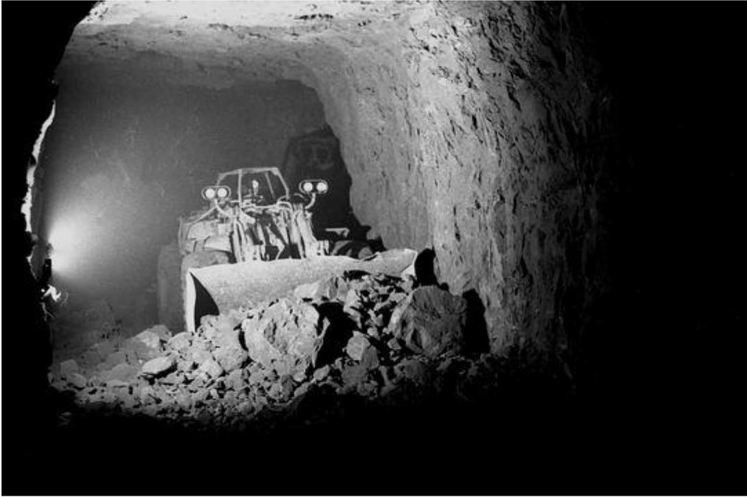
Figure 7 : Caterpillar 980 : Remplissage du godet
