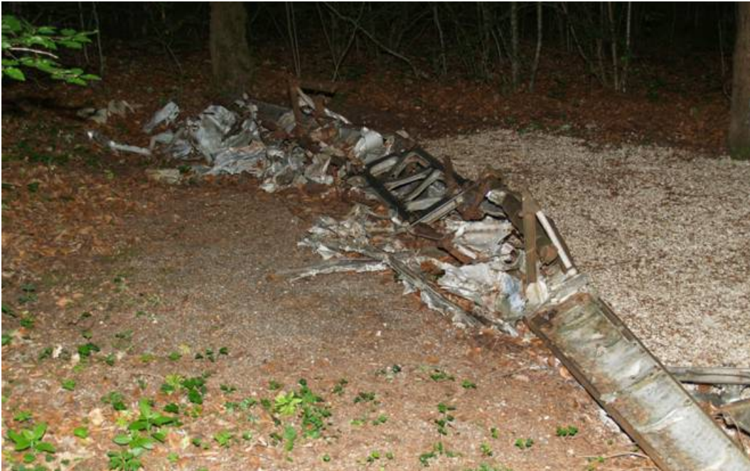
Le longeron principal de la voilure du Morane Saulnier 406 n° 684 d'Emile Boymond et une jambe de son train d'atterrissage
