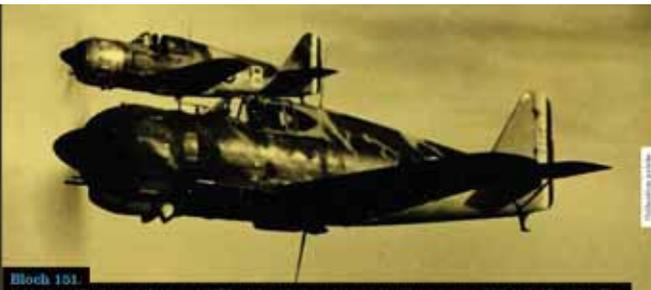
Bloch 151. Ce chasseur issu des spécifications de 1934 est d'architecture et de construction analogues au MS 406 et Dewoitine 520. Équipé d'un propulseur G et R en étoile de 500 cv, il est armé par 4 mitrailleuses de 7,5. Il revendique une vitesse maximale de 320 km/h, un plafond de 11 000 m et une autonomie de 540 km. 69 appareils ont été livrés avant l'armistice, 155 victoires homologuées et 59 pertes pendant la campagne.
